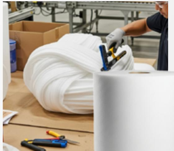
El foam de polietileno es un material no abrasivo, fuerte y ligero, con excelente resistencia al desgarre.
